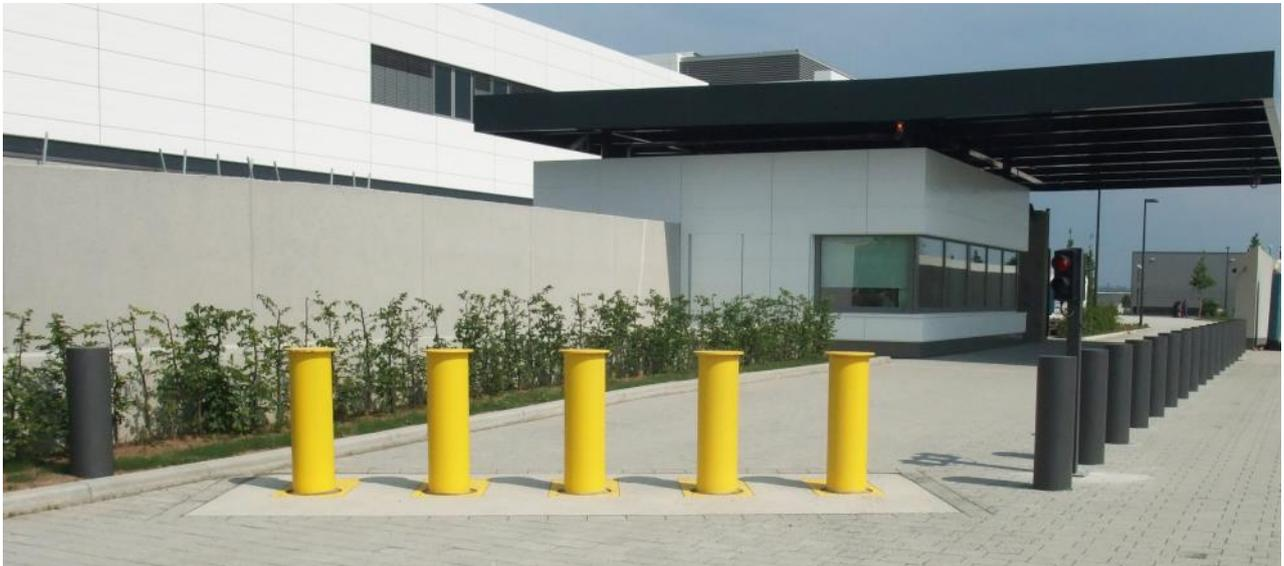
Poller: Erhältlich als elektrohydraulisch angetriebene oder feststehende Poller.
