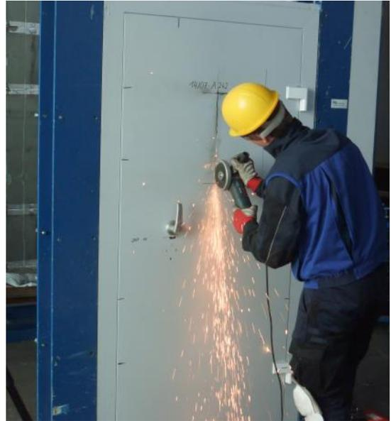
Einbruchtest in der höchsten Schutzklasse RC6; mit elektrischen Werkzeugen wie z.B. Winkelschleifer geprüft.
