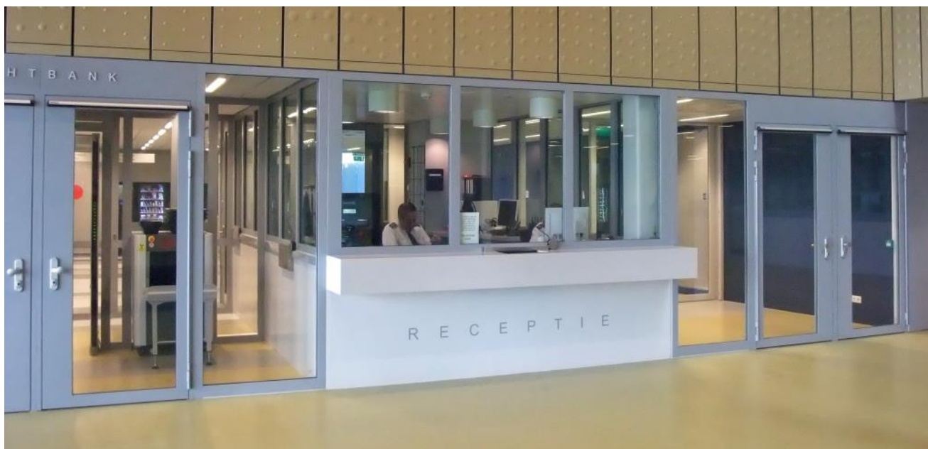
Eingang zu einem Sicherheitsbereich im Flughafen: Wachkabine mit mehreren Schalterfenstern, Trennwänden und Türen. 2 separate Eingänge, Schleusenanlage zur Personenüberprüfung.
