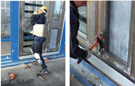
Hart getestet mit Kuhfuß und Axt. Gemäß Norm wird die Tür in der Sicherheitsklasse RC4 zusätzlich mit einem Akkubohrer geprüft.
