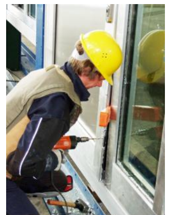
In den Einbruchtests gemäß Europäischer Norm DIN EN 1627-1630 werden ab der Widerstandsklasse RC4 (bzw. WK4) elektrische Einbruchwerkzeuge eingesetzt. In obigem Foto versucht der Prüfer eines renommierten deutschen Testinstitutes die Schlossseite der SÄLZER Aluminiumtür Serie S6 energie sparend mittels elektrischer Bohrmaschine aufzubohren.
