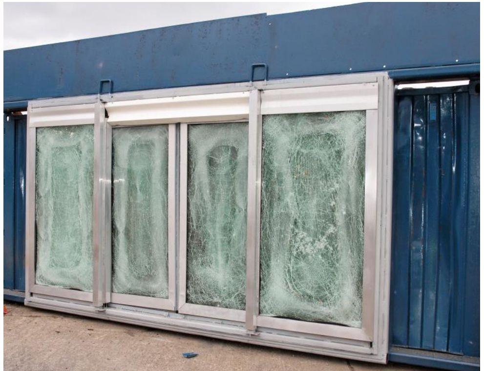
2-flg. Schiebetür mit Seitenteilen, Größe 4,405 x 2,530 m, erfolgreich mit 500 kg Sprengstoff getestet. Verglasung und Rahmen hielten der extremen Druckwelle von über 24 Tonnen Druck pro qm stand.
