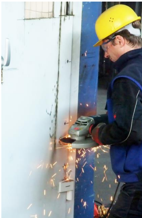
Mit einem Winkelschleifer (Scheiben Ø 230 mm) versucht der Prüfer Zugriff auf die Bandsicherungen zu erhalten.
