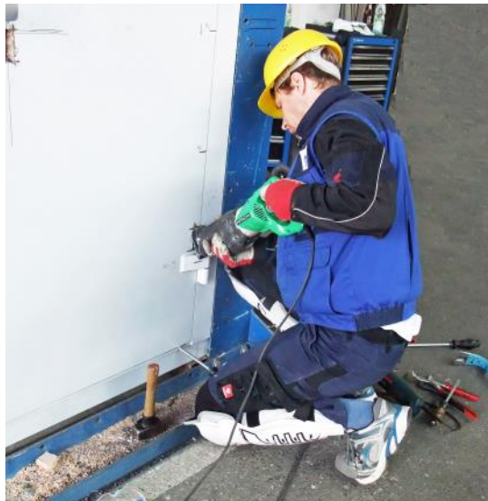
Der Prüfer des akkreditierten Prüfinstitutes versucht mit einer Säbelsäge die Bänder der Tür abzusägen, erfolglos wie das Zertifikat bestätigt.
